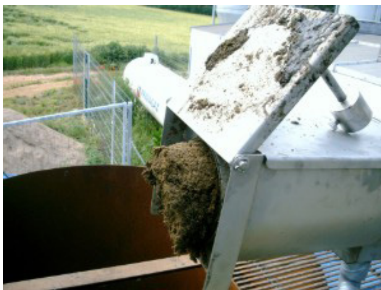
FOTO 5: SEPARADOR DE SÓLIDOS POR SISTEMA DE TORNILLO Y PRENSA
