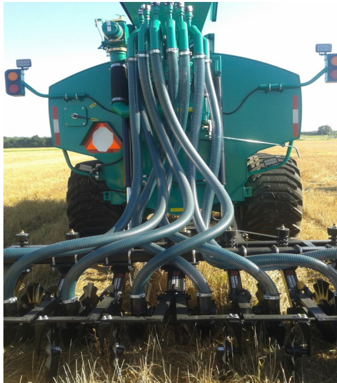
FOTO 7. INYECCIÓN DE EFLUENTES LÍQUIDOS
